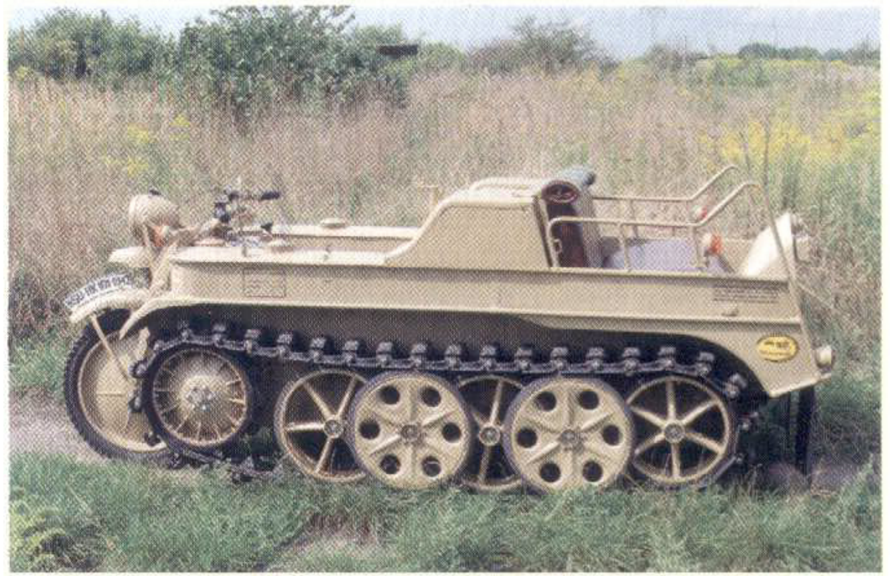
Bardzo skomplikowany pojazd zabierał oprócz kierowcy tylko dwie osoby lub sporo ładunku
