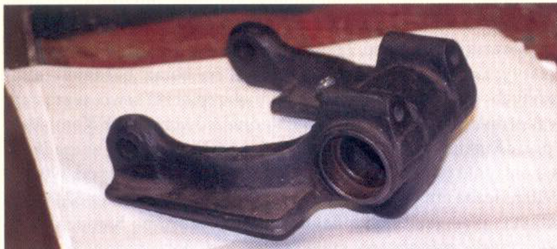
Pojedyncze ogniwo gąsienicy wyposażone w zbiornik smaru może wzbudzać zachwyt swoją konstrukcją, ale koszt jego wykonania musiał przekraczać granice rozsądku. Każde ogniwo musiało być wiercone, frezowane i szlifowane oraz utwardzane powierzchniowo
