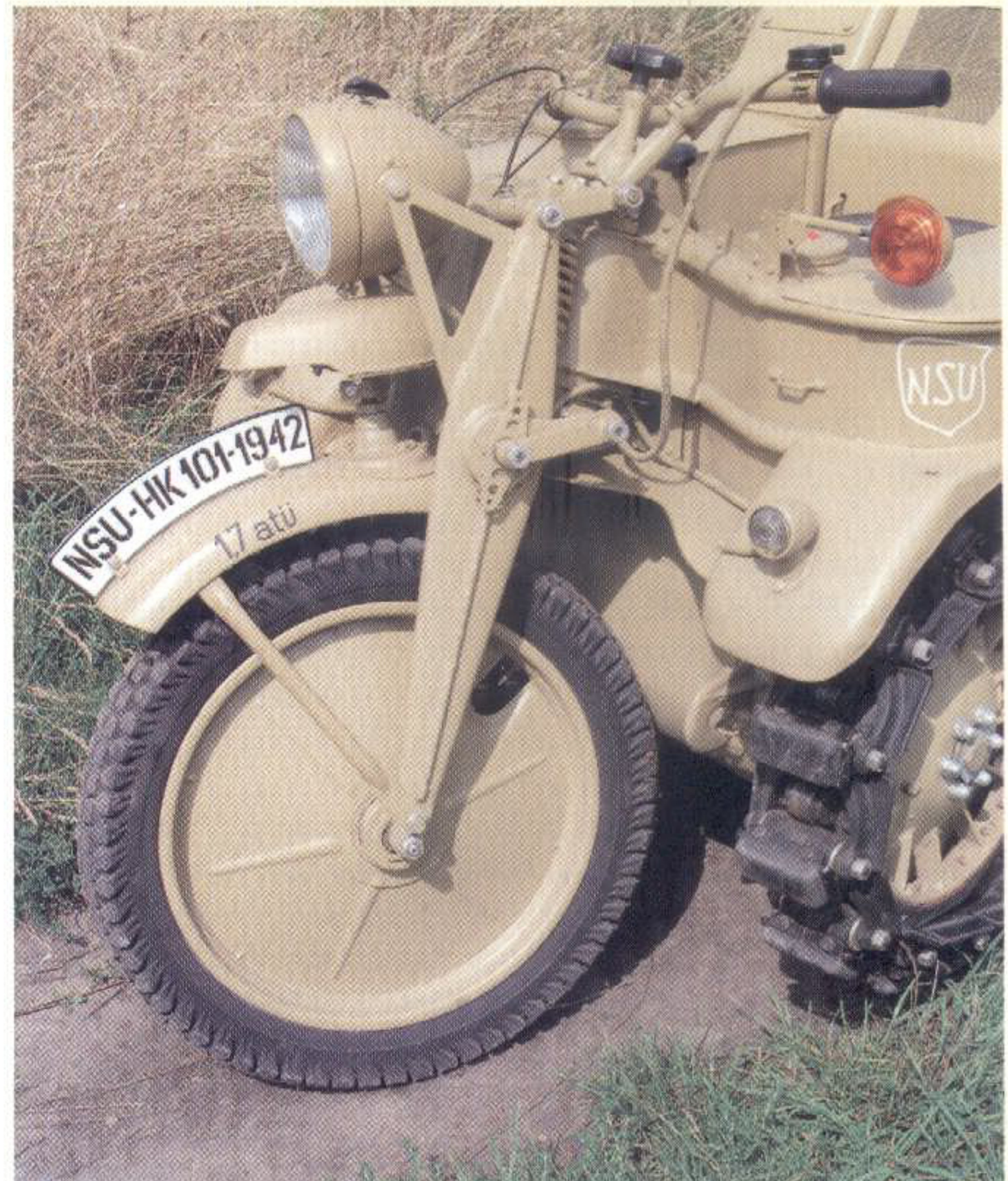
Niezwykle solidne trapezowe zawieszenie przedniego koła jest chyba jedynym łącznikiem tej konstrukcji z motocyklami
