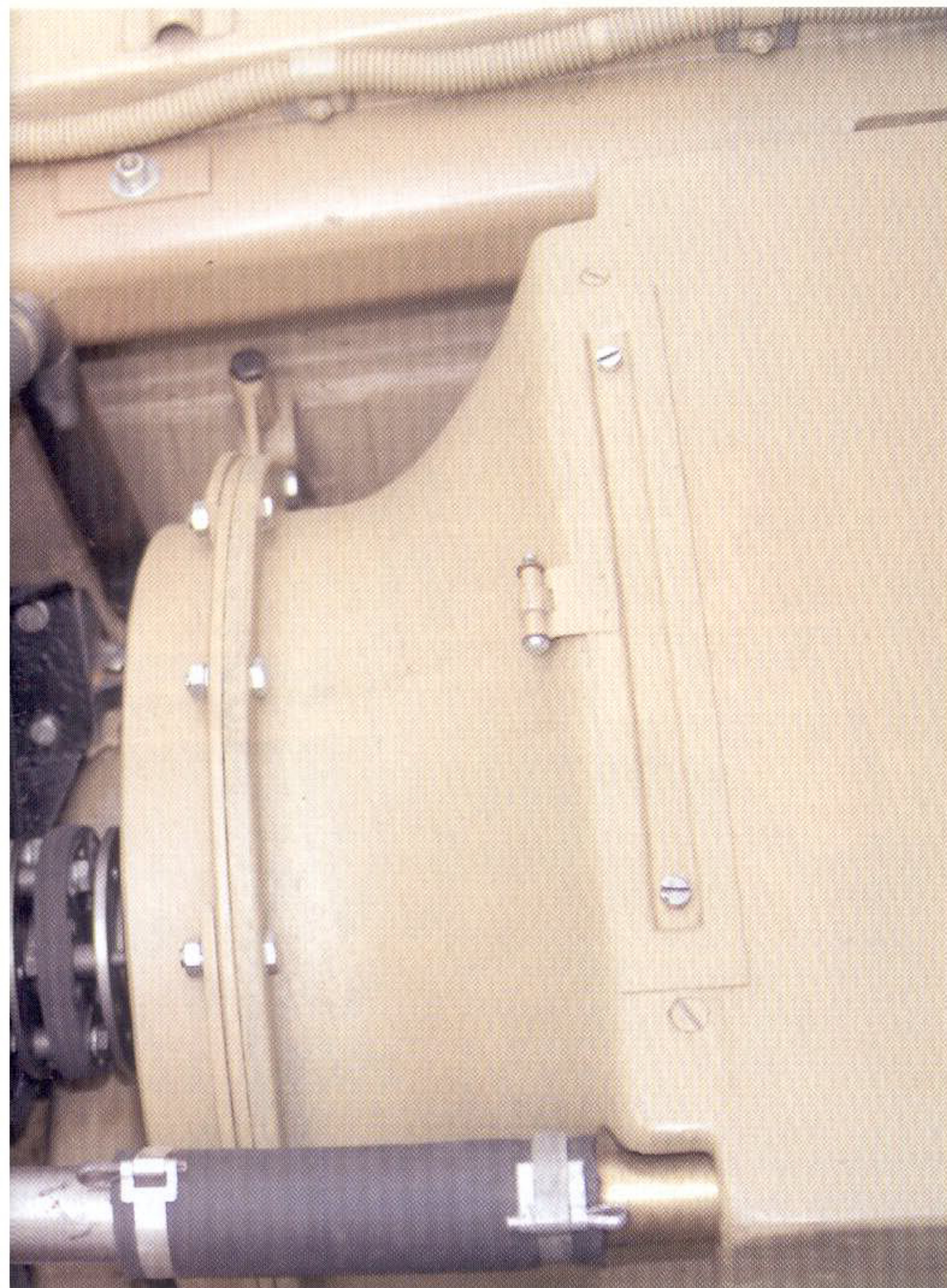
Układ chłodzenia stał się właściwie oddzielnym agregatem dla całkowicie schowanego silnika i chłodnicy
