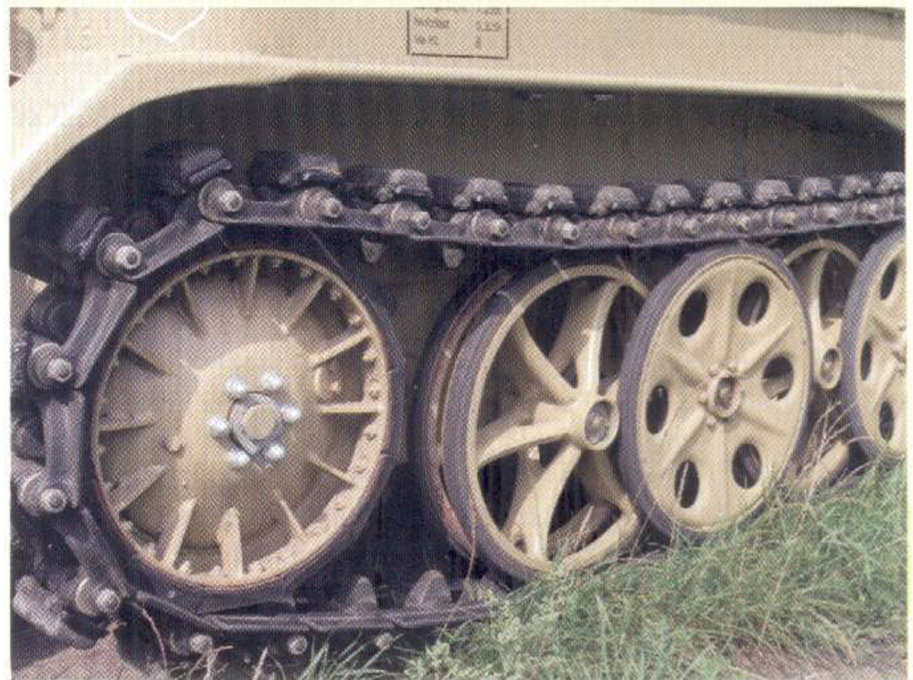
Dzięki niezwykle skomplikowanej konstrukcji gąsienic, układ jezdny typowy dla czołgów stawia bardzo małe opory toczenia
